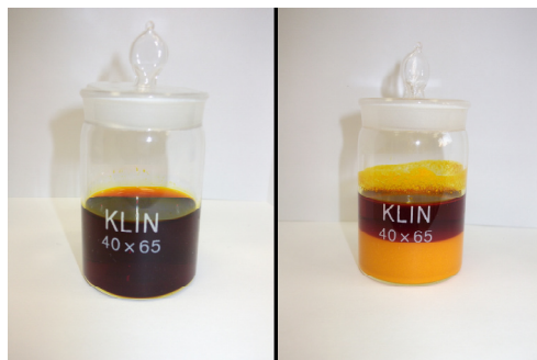
Рис. 1. Удаление катионов трехвалентного железа из стандартного электролита хромирования с помощью добавки АМ 334. Слева – исходный электролит, справа – после введения добавки АМ 334, перемешивания и отстаивания в течение суток
