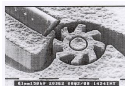
Рис.2.2. Крыльчатое колесо, изготовленное методом микрогальваники (метод ЛИГА) 6
