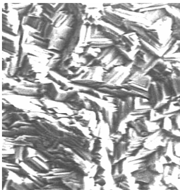
Рис.5.3. Рельеф внешней поверхности осадка цинка, полученного из стандартного электролита без регуляторов роста (сканирующая электронная микроскопия, x 1200) 19
