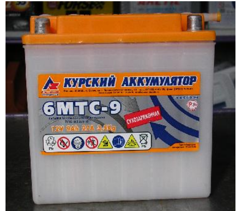
Рис.6.1 Коммерческая свинцовая сухозаряженная аккумуляторная батарея, имеющая параметры: напряжение 12 В, емкость 9 А·ч, ток короткого замыкания 27 А при 18 °С, масса 3,5 кг
