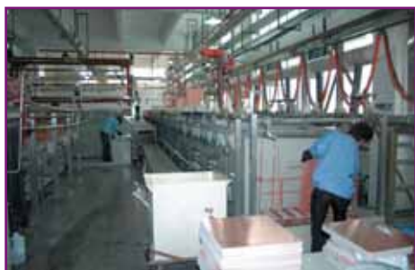
Рис. 2. Химико-гальваническая линия с производительностью 24 м 2 /ч
