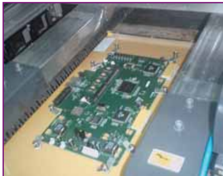
Рис. 12. На пайку волной платы поступают в оснастке, предотвращающей коробление и ограничивающей зоны контактирования припоя с поверхностью платы
