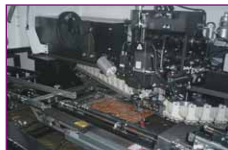
Рис. 11. Автомат установки «дырочных» компонентов в отверстия печатных плат
