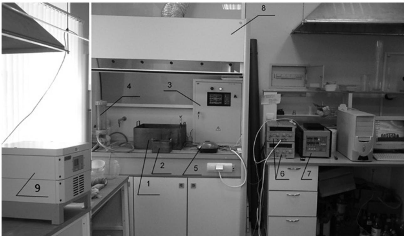
**Рис. 1. Фотография лабораторной установки нанесения гальванопокрытий.** 1 – титановая ванна объёмом 25 л; 2 – титановая ванна объёмом 1,5 л; 3 – четырёхканальная система управления температурой гальванических ванн; 4 – фильтровальная установка МС10-СО552; 5 – устройство подачи воздуха для барботажа электролита; 6 – лабораторные источники питания Б5-1820; 7 – промышленный выпрямительный агрегат Пульсар Про 50/12 54; 8 – вытяжной шкаф; 9 – промышленный выпрямительный агрегат Flex Kraft
